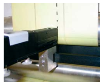
Abbildung 4: Aufbringen des Positionskodes über Inkjet-Drucker.
